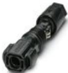
Photovoltaik-Steckverbinder, Artikelfamilie: Sunclix, Steckverbinder, Material Gehäuse: PPE, Farbe: schwarz, Polzahl: 1, Aderquerschnitt min.: 2,5 mm<sup>2</sup>, Aderquerschnitt max.: 6 mm<sup>2</sup>, Bemessungsspannung: 1100 V DC, Bemessungsstrom: 40 A, Anschlussart: Federkraft, Kontaktart: Stift, Kabeldurchmesser min.: 5,5 mm, Kabeldurchmesser max.: 8 mm
