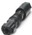
Photovoltaik-Steckverbinder, Artikelfamilie: Sunclix, Steckverbinder, Material Gehäuse: PPE, Farbe: schwarz, Polzahl: 1, Aderquerschnitt min.: 6 mm<sup>2</sup>, Aderquerschnitt max.: 16 mm<sup>2</sup>, Bemessungsspannung: 1500 V DC, Bemessungsstrom: 65 A, Anschlussart: Federkraft, Kontaktart: Stift, Kabeldurchmesser min.: 5,5 mm, Kabeldurchmesser max.: 10 mm
