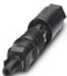
Photovoltaik-Steckverbinder, Artikelfamilie: Sunclix, Steckverbinder, Material Gehäuse: PPE, Farbe: schwarz, Polzahl: 1, Aderquerschnitt min.: 6 mm<sup>2</sup>, Aderquerschnitt max.: 16 mm<sup>2</sup>, Bemessungsspannung: 1500 V DC, Bemessungsstrom: 65 A, Anschlussart: Federkraft, Kontaktart: Buchse, Kabeldurchmesser min.: 5,5 mm, Kabeldurchmesser max.: 10 mm
