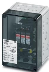
Generatoranschlusskasten für Photovoltaikanlagen bis 1000 V DC zum Anschluss von 1x 1 String. Mit Überspannungsschutz und SUNCLIX DC-Steckverbinder für die Eingangs- und Ausgangsseite.
