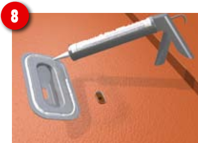
Kleberraupe (Ø 10mm) auf angeschliffenen und gereinigten SUNNY auftragen.
