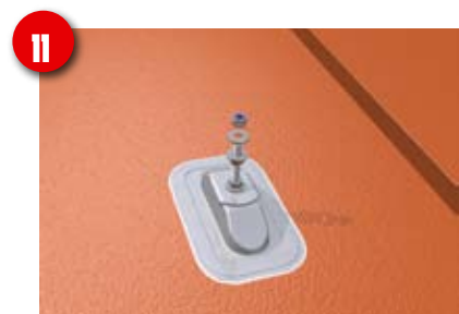
Mutter und Beilagescheibe zum Befestigen des Solarprofils aufschrauben.
